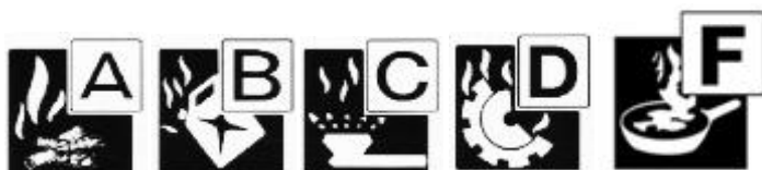
Kuva 1. Käsisammuttimien paloluokat kertovat, minkä tyyppisiä paloja sammuttimella voi sammuttaa.
